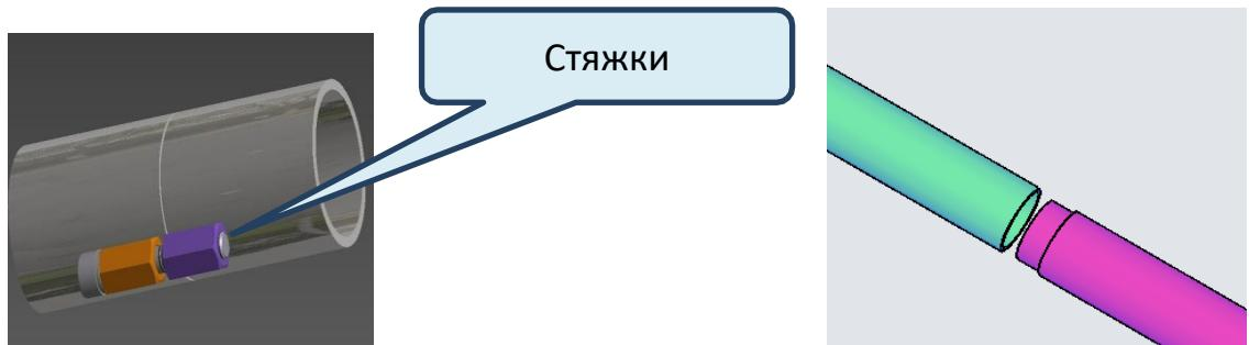
7. При установке секций, завести через конец направляющей трубы одной из секций нижнюю каретку охватывая трубу роликами и закрепить каретку от произвольного перемещения мягкой проволокой.
